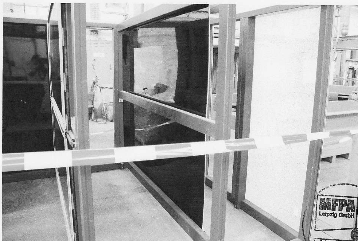
Abbildung 2: Rahmen mit eingebauten Glasscheiben (Rückseite)
