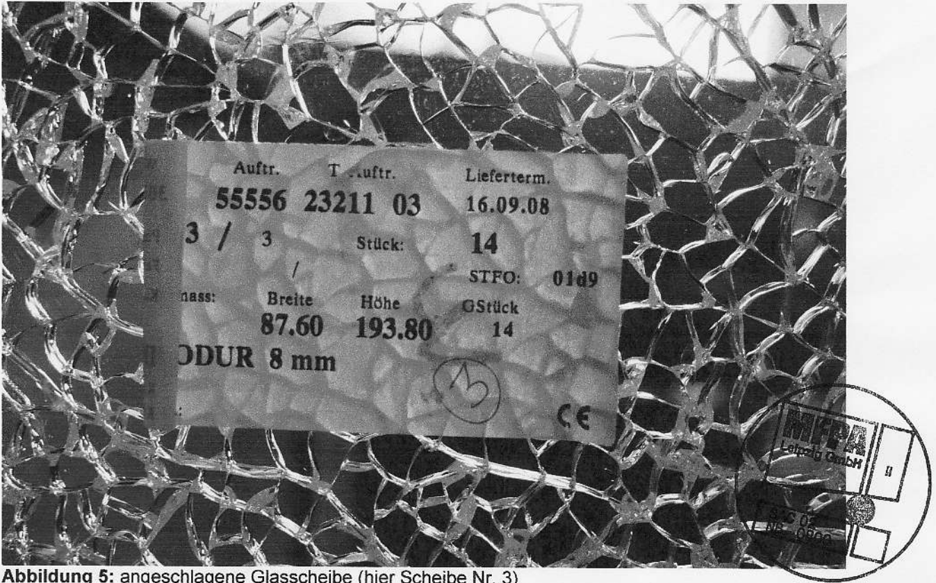
Abbildung 5: angeschlagene Glasscheibe (hier Scheibe Nr. 3)
