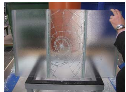
Bild 5 PK 12 nach Kugelfallversuch, Auftreffstelle Mitte
