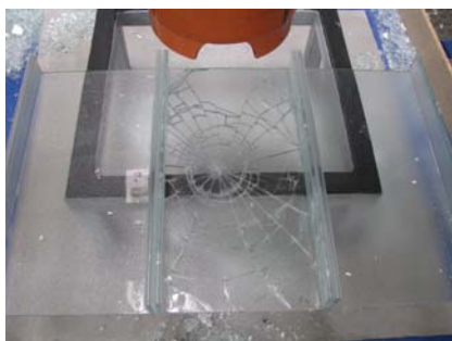
Bild 6 PK 12 unteres Profilbauglas nach Kugelfallversuch
