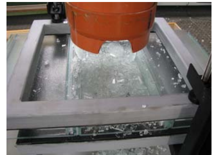
Bild 5 PK 12 nach Kugelfallversuch, Auftreffstelle Mitte
